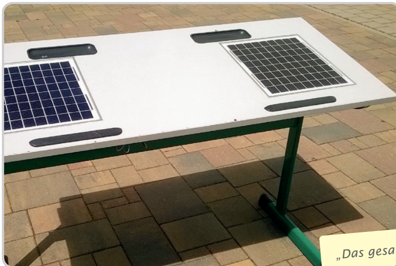
Prototyp des Solarladetisches, der das Aufladen von Geräten, wie Smartphones, ermöglicht
